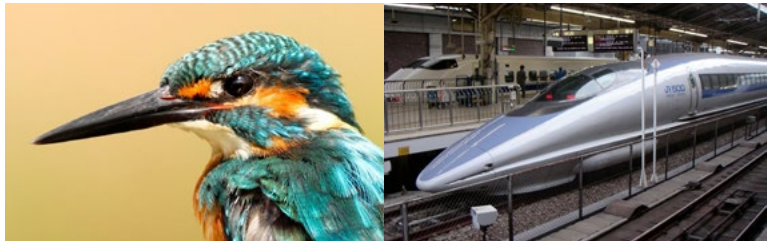
Paruh burung raja menjadi model rujukan bagi kon hidung kereta api berkelajuan tinggi Shinkansen Siri 500 di Jepun
